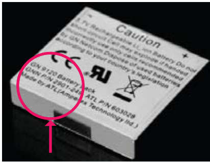
标示” Made by ATL” 的电池须换成贴有Synergy标签的电池
