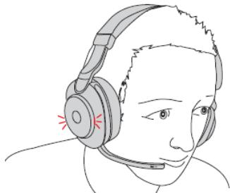
Bei den Microsoft Teams-Headsetvarianten wirkt sich das manuelle Ausschalten der Busylights nur auf die roten LEDs aus. Die violetten LEDs können nicht manuell ein-/ausgeschaltet werden.
