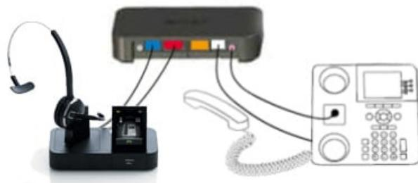
Tenga presente que el teléfono no estará totalmente operativo hasta que las marcas de color de todos los cables se hayan conectado al adaptador EHS, como se muestra en la foto.
